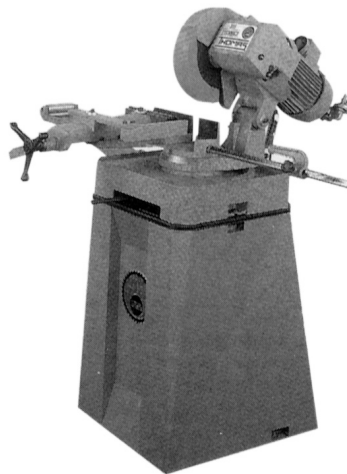
figuur 3.14 Met een cirkelzaagmachine kun je veiliger werken dan met een haakse slijpmachine.
